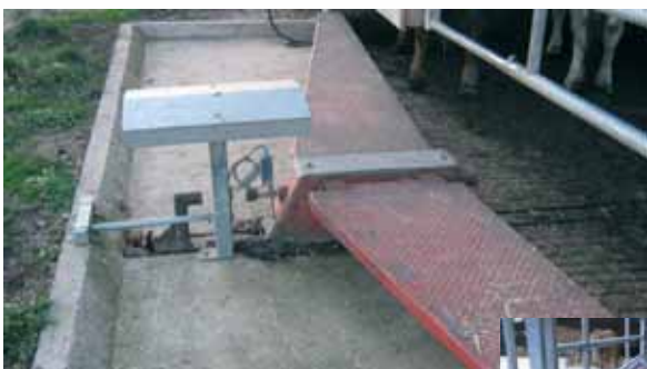
Mise en parc d'un racleur grande largeur avec système d'arrêt automatique.
