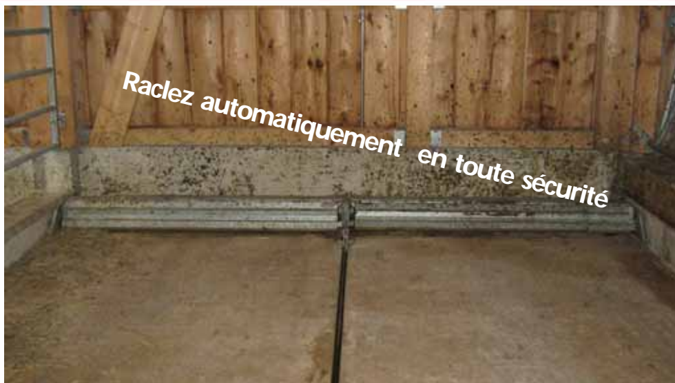
Racleur compact à volets fixes (en option volets mobiles)
