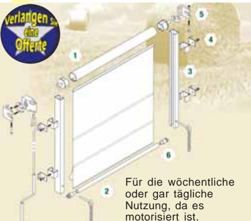
Als Option, die Straffer aus Aluprofil sind jeden Meter vorgesehen. Sie ermöglichen die Installation dieses Systems auf eine Höhe von über 4 Metern.
