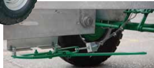
Feststellbremse unter der Zistern für mehr Sicherheit
