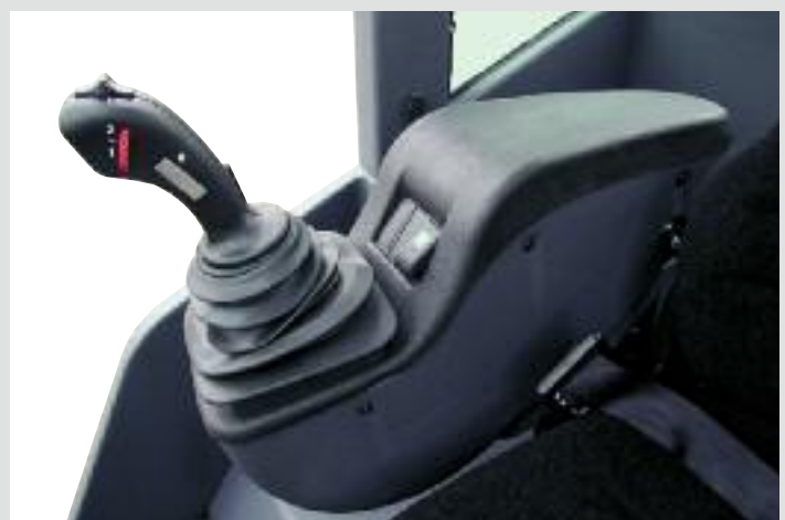
L'accoudeur, ainsi que le joystick forment une seule unité avec le siège et suivent les mouvements de celui-ci, ce qui permet au conducteur de garder la forme pendant toute la journée.
