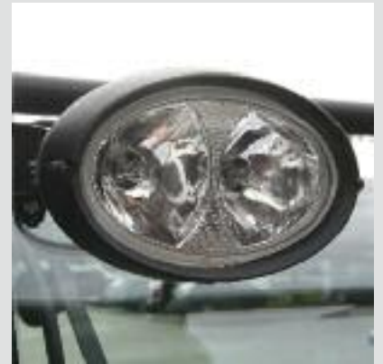
2 phares double de travail avant 1 phare double arrière
