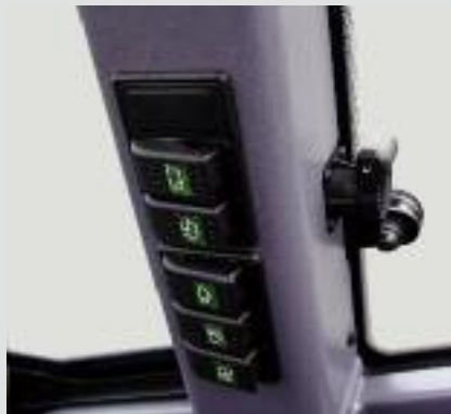
Commande centralisée groupée Prise 12 V
